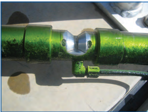
spectro::lyser et l'efficacité de son nettoyage à l'air comprimé
