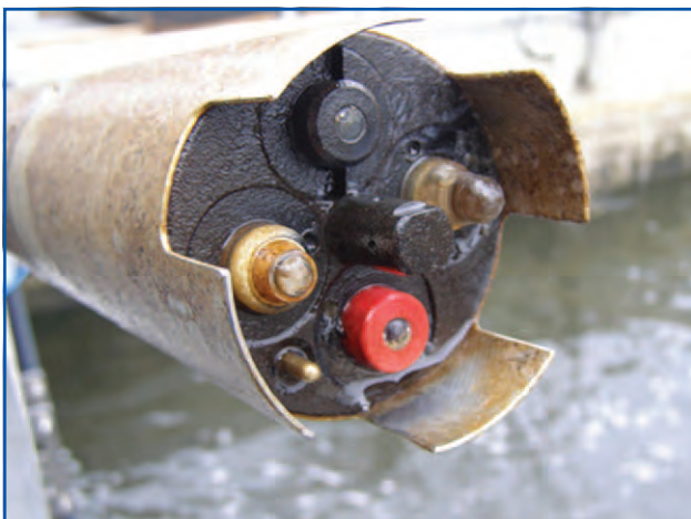
ammo::lyser en sortie de STEP
