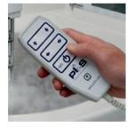
L'unité de contrôle La commande permet le mouvement horizontal et vertical et fonctionne avec sa station de base, de recharge du Cryo-Lift.
